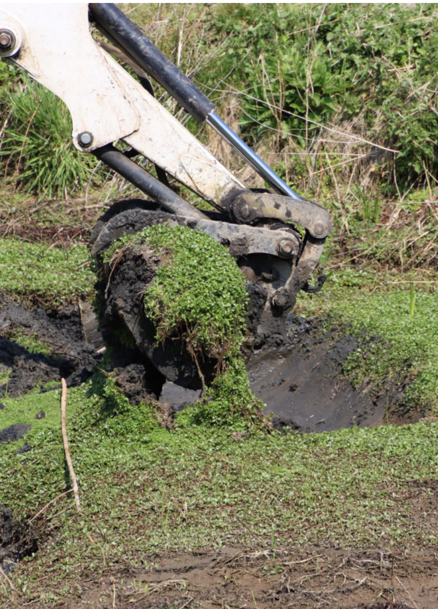
Fig 36. Mechanisch baggeren van waterleensbloem na een volledige drooglegging van het waterlichaam . Foto: Arnaud Monty.
