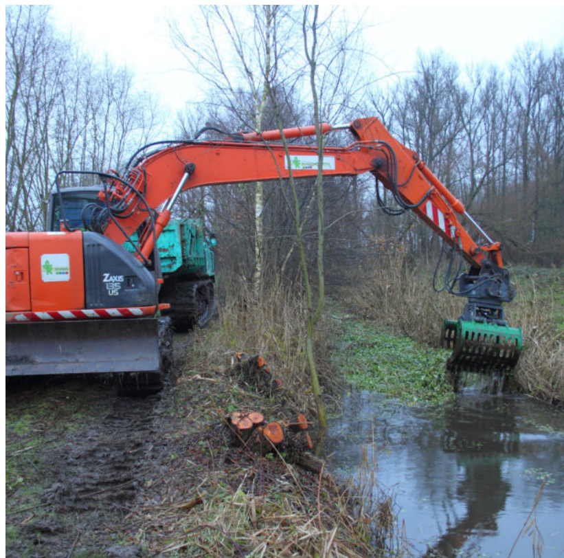
Fig 23. Graafmachines die op de oever blijven staan, worden gebruikt voor het verwijderen van grote waternavel uit een stelsel van smalle waterwegen. Foto: Jérémie Guyon.
